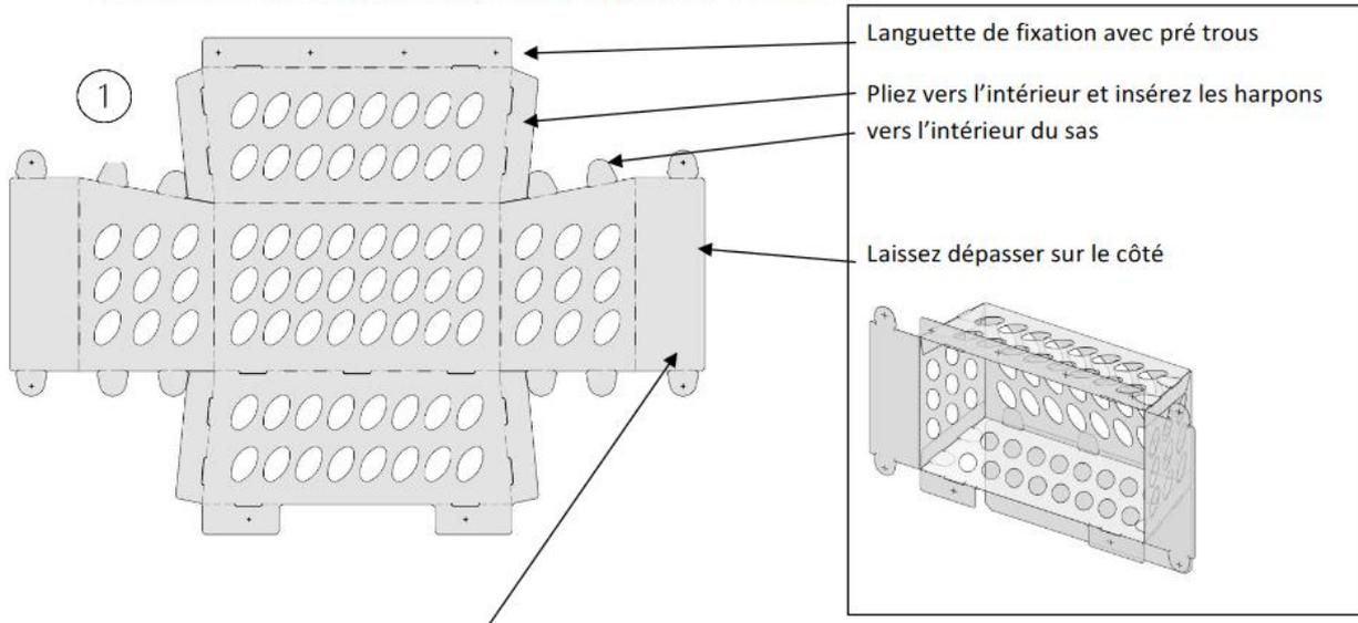
Mesurez votre plancher de ruche et découpez selon les dimensions afin que le plancher du sas repose sur la planche d'envol
