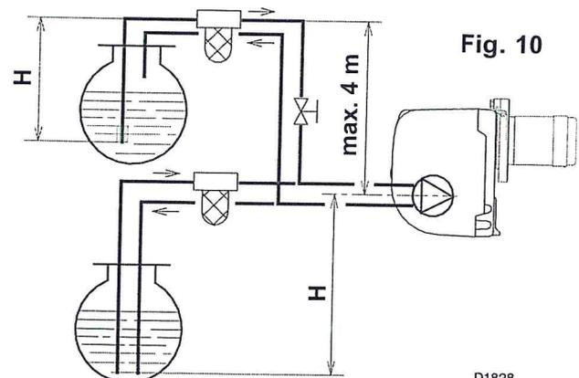
Il est nécessaire d'installer un filtre sur la ligne d'alimentation du combustible.
