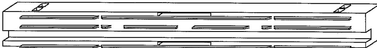
Permet de réaliser un fond de ruche réversible qui peut être grillagé avec des coulisses réglables à fermer uniquement au printemps (lutte contre les varroas), ou une trappe de fond à pollen.
