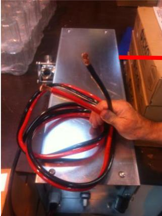
Brancher les deux câbles au plus et au moins de la batterie.
