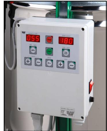
Réalisés en acier inox 18/10 de première qualité. Équipés du moteur SAF NATURA 220 Volt modifié en 30 volt, **150 Watt**. Frein/friction automatique. Programmateur automatique avec bloc de sécurité sur le couvercle. Pour pouvoir ouvrir le couvercle, la cage de l'extracteur doit être arrêtée. Frette et **robinet Ø 50 mm en acier inox**
