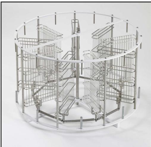
Cage XSARA réversible, composée de 9 petits paniers. Pour 9 cadres Langstroth. En changeant le sens de rotation, la cage peut extraire en tangentiel les cadres de deux côtés sans besoin de tourner le cadre. Dimensions de chaque panier mm 247 x 45 x 410 H. Entièrement en acier inox
