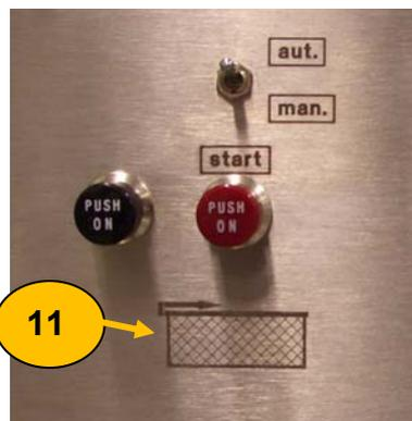
Si le commutateur est sur MAN, la machine fonctionne en mode manuel.
