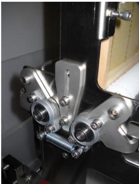
Il est possible de régler l'ouverture ou la fermeture des rouleaux en agissant sur la patte en forme de triangle, il suffit de desserrer les vis de blocage et de la fixer dans la position désirée.
