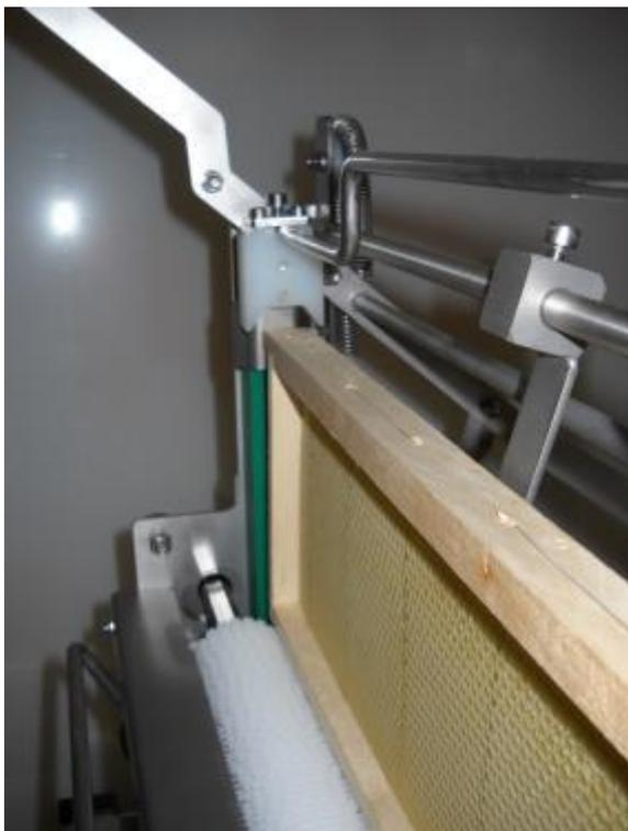
Placer le cadre en position verticale, en posant la partie inférieure entre les deux rouleaux et en insérant le porte-cadre entre les deux glissières en PE blanches, jusqu'à ce qu'il soit soutenu par la glissière d'appui centrale.
