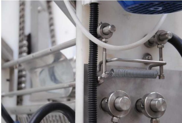
Fig. 6 vis pour ajuster le cadre de serrage
