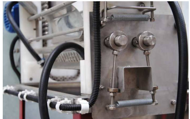
Fig. 8 vis pour ajuster les lames désoperculation
