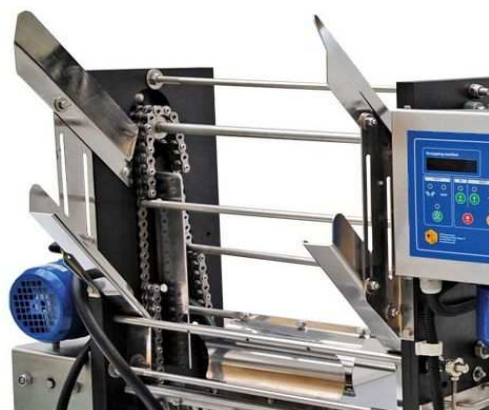
Fig. 5 corriger l'alignement des cadres dans les coulisses.
