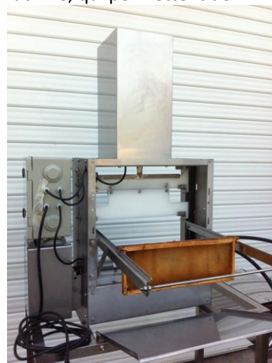
cadre désoperculé sur les deux glissières arrière de stockage
