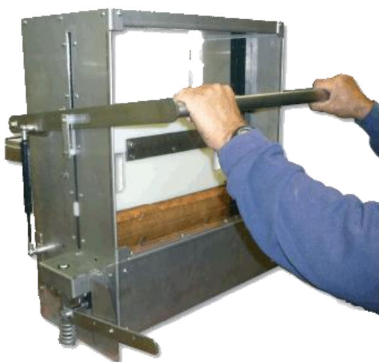
dans la version manuelle, le cadre est descendu et remonté en actionnant le levier en façade.
