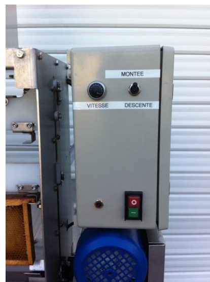
Dans la version électrique, l'opérateur tient le bouton appuyé pour la descente, le mouvement est arrêté dès que le bouton "descente" est lâché. Pour la remontée, l'opérateur relève le bouton sur "montée" et le cadre remonte. Un variateur de vitesse permet de régler la vitesse du déplacement du cadre
