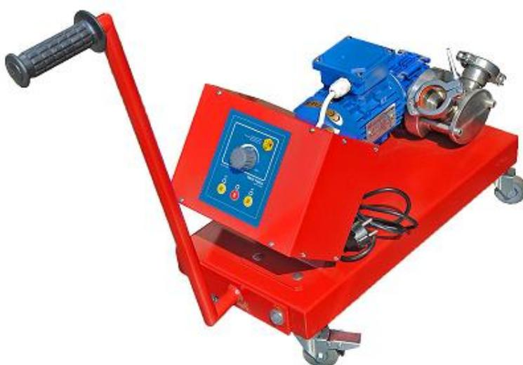
Pompe Varimel à rotor flexible avec accouplement direct au motoréducteur. Aspirante et refoulante. Moteur triphasé avec variation électronique de vitesse dans les 2 sens de rotation. Alimentation en 220 volts.
