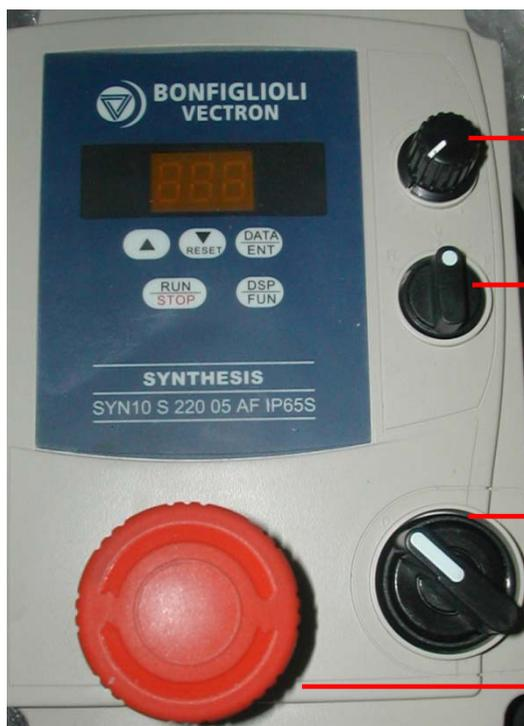
Potentiomètre, réglage de la puissance
