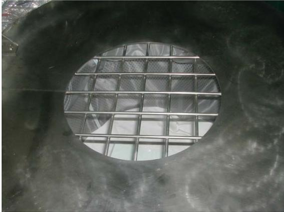
Orifice par lequel les opercules et le miel rentrent et tombent dans le panier.
