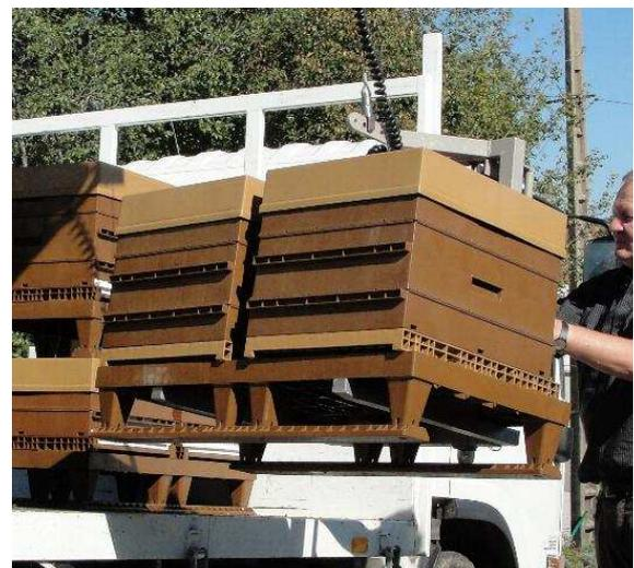
Pour une meilleure répartition de la charge, des nouvelles fourches de longueur 530mm ont été réalisées avec des barres de section 40x40mm, en gardant le même écartement.
